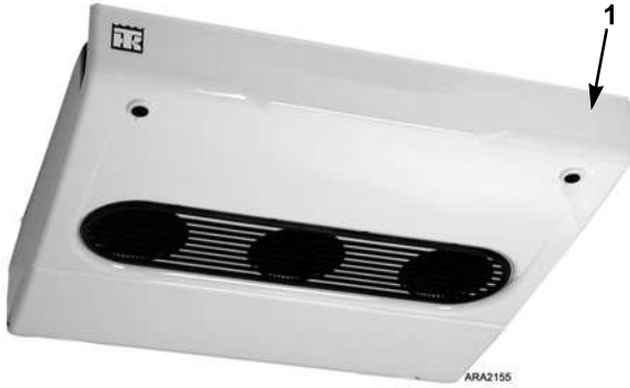
Figure 21. Emplacement de la plaque signalétique avec le numéro de série (Illustration du S-3, le S-2 est similaire)
